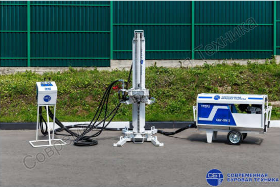
Фото СБГ-ПМ-03 с основанием для вертикальных скважин
